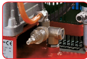
2 Valvola messa a vuoto di grandi dimensioni.
